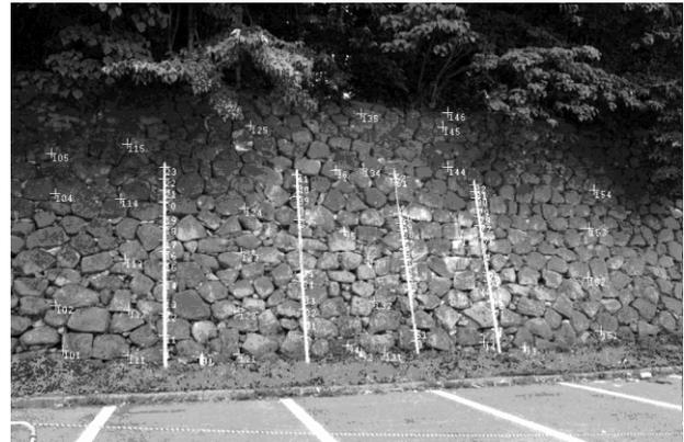
図-7 ダミー標点(スタッフ上)と計測点(石垣上)
